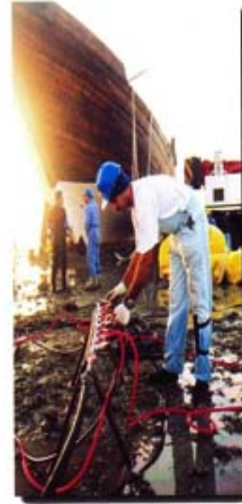
أحد أعضاء الفريق يستخدم الموزع المركزي للهواء الخاص بتعبئة الحقايب الهوائية.
